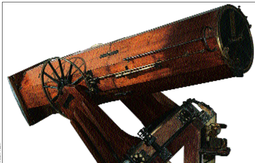
4. CE TÉLESCOPE ÉQUIPÉ D'UN MIROIR DE 20 centimètres de diamètre (à gauche) fut réalisé par Foucault, qui appliqua une mince couche d'argent sur la face avant d'un bloc de verre poli, concave. Il mit au point des techniques pour fabriquer des miroirs bien plus grands, ouvrant ainsi la voie aux télescopes à réflexion géants. Le plus grand des télescopes de Foucault ( ci-dessus ), qui possède un miroir en verre argenté de 80 centimètres de diamètre, fut réalisé à Paris au début de 1862. Il fut ensuite installé à l'Observatoire de Marseille, où il fut utilisé pendant une centaine d'années. Ce télescope fait aujourd'hui partie du patrimoine historique français.
